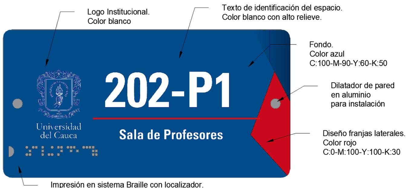
Ilustración 4. Plantilla Institucional base para diagramación de placas de señalización informativa.
